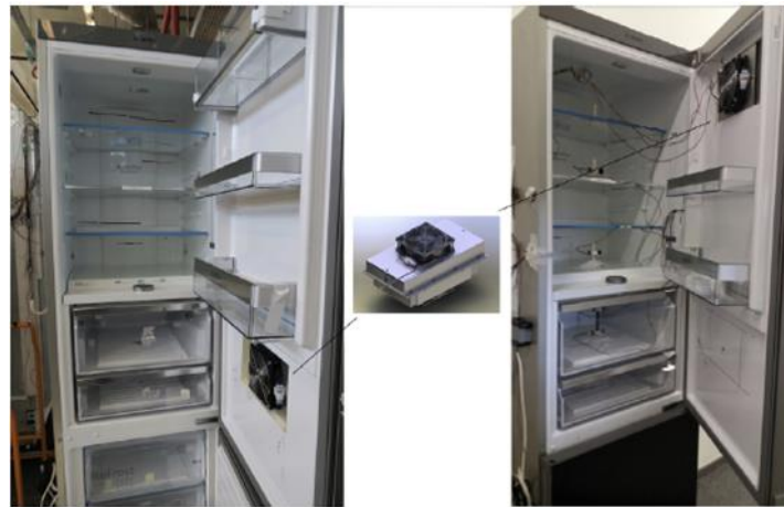
Şekil 3. Ev tipi hibrit buzdolabında termoelektrik modülün farklı konumlandırma fotoğrafları (Söylemez ve ark., 2012).
