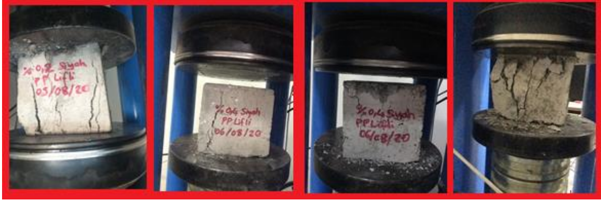
Şekil 27. Basınç testi sonrası numune çatlak durumları
