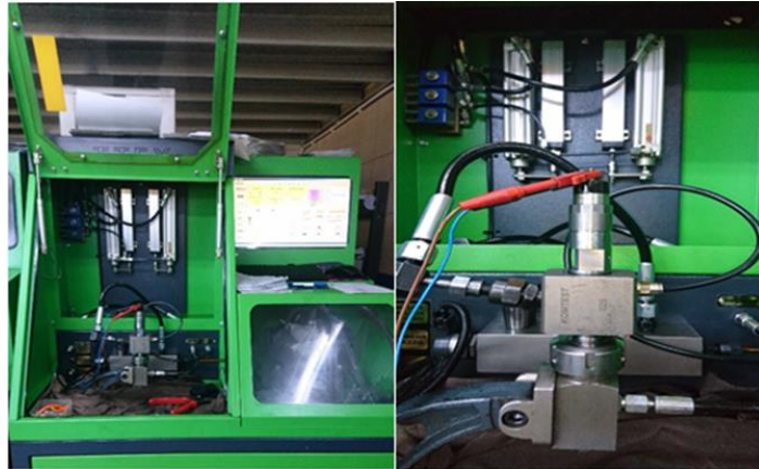
Şekil Hata! Belgede belirtilen stilde metne rastlanmadı..5 Enjektör çalışma testinin yapılması
