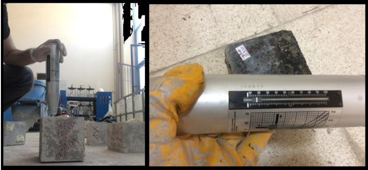
Şekil 7. Beton test çekici deneyi uygulaması
