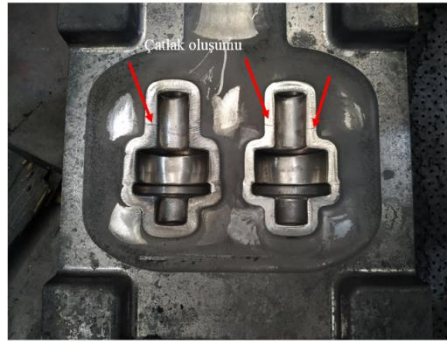
Şekil 7. Sıcak dövme kalıbında ısıl yorulma sonrası çatlak başlangıcı
