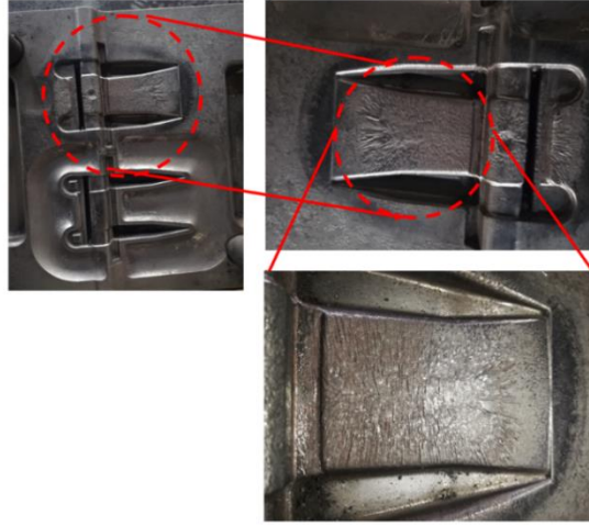
Şekil 6. Sıcak dövme kalıbında ısıl yorulma sonrası oluşan sıcak çatlaklar
