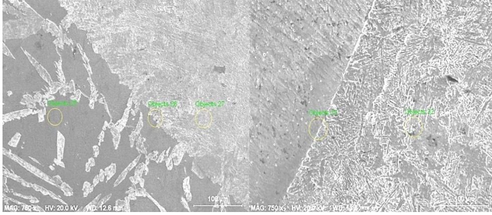
Şekil 3. N3 numunesinden alınan EDS analiz noktaları gösteren SEM fotoğrafı.
