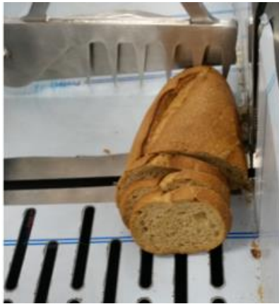
Şekil 3. Akıllı yenilikçi otomatik dilimleme makinası prototipinde dilimleme süreci fotoğrafı.
