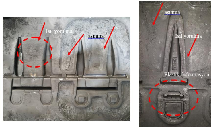
Şekil 8. Sıcak dövme kalıbında plastik deformasyon, ısıl yorulma ve aşınma oluşumu
