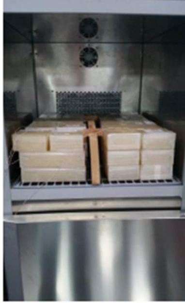
Şekil 9. Enerji tasarrufuna katkı sağlayan yenilikçi hibrit endüstriyel buzdolabı prototipinin test ve değerlendirme aşamasında test paketleri ile soğutma haznesinin doldurulması görünüşü.
