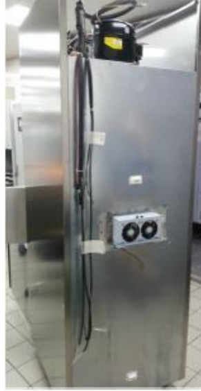
Şekil 7. Enerji tasarrufuna katkı sağlayan yenilikçi hibrit endüstriyel buzdolabı prototipinin arka görünüşü (termoelektrik modülü).
