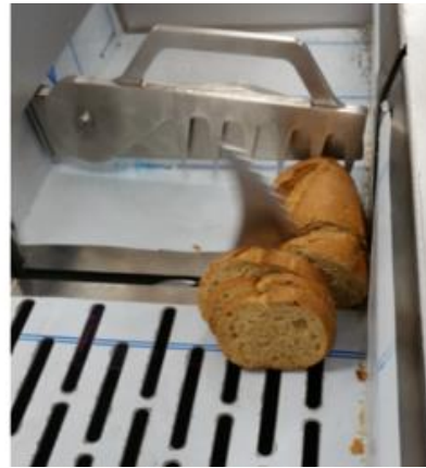
Şekil 3. Akıllı yenilikçi otomatik dilimleme makinası prototipinde dilimleme süreci fotoğrafı.
